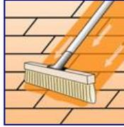
Mit Pinsel oder Rolle gleichmäßig dünn und flächig auftragen
